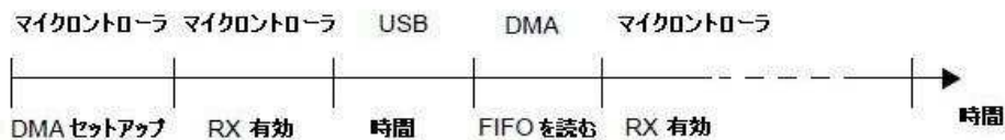
図9. 標準DMAモードにおける受信動作
