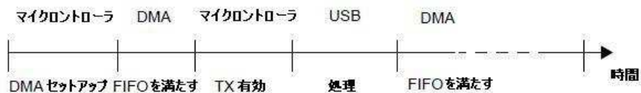
図8. 標準DMAモードにおける送信動作
